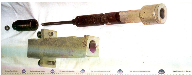
Bild 6: Hülse mit Tellerfedersäule eines Spannelementes
