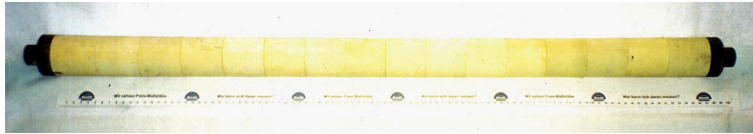
Bild 3: Rostelement 1000 mm lang aus 16 Einzelzylindern, Durchmesser 60 mm
