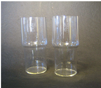
Abb. 09: Chemisch verfestigte Biergläser aus der Versuchsproduktion in Bad Muskau (Beregnungsverfahren)
