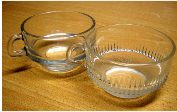
Abb. 08: Im Tauchverfahren verfestigte Pressglastassen von 1973
