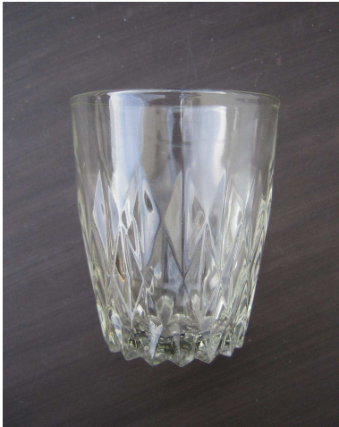
Abb. 13: Luftverfestigter Pressglas-Becher aus der Sowjetunion
