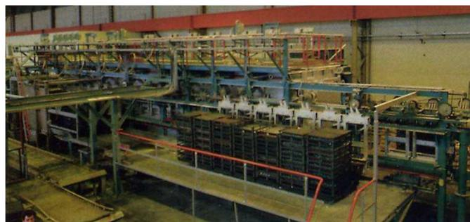
Abb. 36: Teilansicht der CV-Anlage Die Kassettenstapel befinden sich auf den Transportwagen und stehen zum Einfahren in den Ofen bereit
