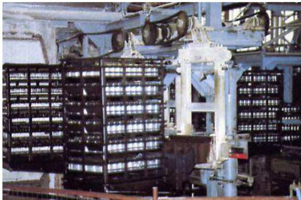
Abb. 37: Die Kassettenstapel haben die CV-Anlage verlassen. An den Bierbechern ist eine weiße Schicht anhaftendes Kaliumnitrat zu erkennen.
