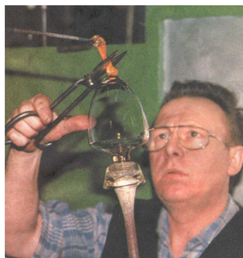
Kelchglasmacher Roland David beim Abschneiden der benötigten Glasmenge für den Stiel, scheinbar Weinkelch „Oberweimar“
